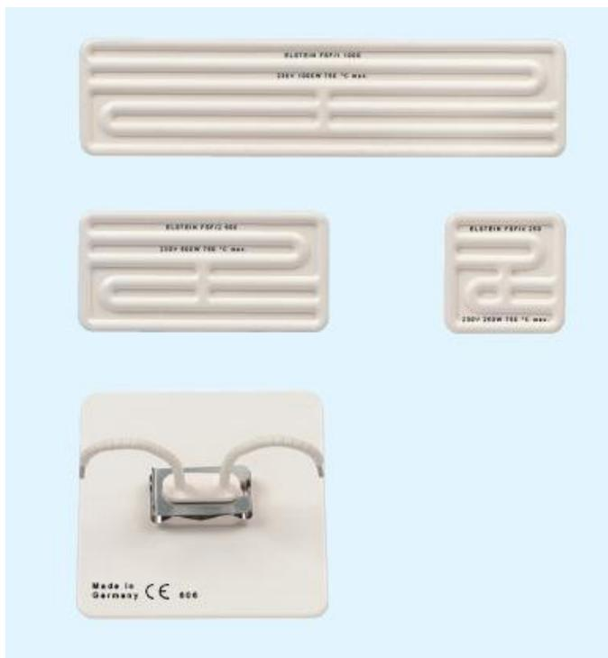
Gli irradiatori ELSTEIN FSF sono caratterizzati da uno spessore molto ridotto. Sono realizzati in ceramica piena e progettati per temperature di funzionamento fino a 720°C e potenze specifiche superficiali fino a 64 kW/m<sup>2</sup>. Paragonati con gli altri irradiatori ELSTEIN con zoccolo standard, lo spessore totale degli irradiatori FSF, misurato dalla superficie radiante al piano di fissaggio, risulta ridotto di circa il 45%.
