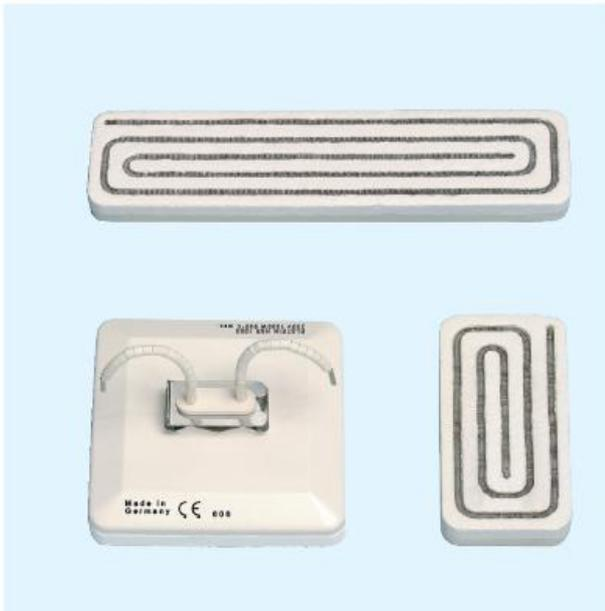
Gli HSR sono irradiatori ceramici ad alta velocità, progettati per temperature fino a 860°C e potenze specifiche superficiali fino a 64 kW/m<sup>2</sup>.
