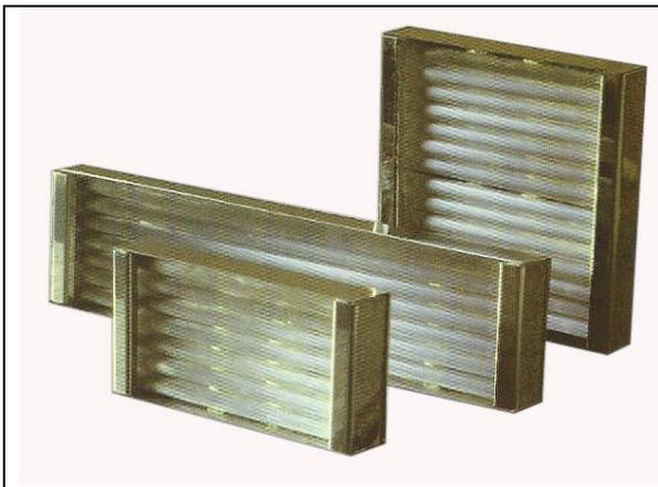
Gli irradiatori infrarossi al quarzo FQE-HTE sono costituiti da una spirale metallica resistiva che viene infilata in una serie di tubi di quarzo; il tutto viene montato in un contenitore in alluminio ad alta riflettività. Il contenitore in alluminio assicura una bassa perdita di radiazione dal retro dell'irradiatore. Tutti gli irradiatori sono provati a carico e per eventuale scarica a terra con tensione 1500V.
